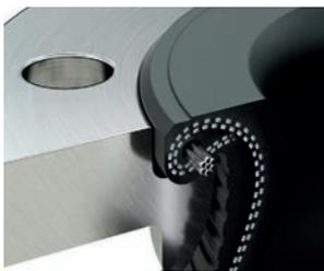
Para diferentes exigencias de presión y temperatura, se utilizan diversos materiales de refuerzo (fibras sintéticas o cord de acero) en la capa intermedia del fuelle de goma. El collarín de goma es autosellante y está reforzado adicionalmente con núcleo de alambre para mayor estabilidad (alambre sobresaliente en la figura).
