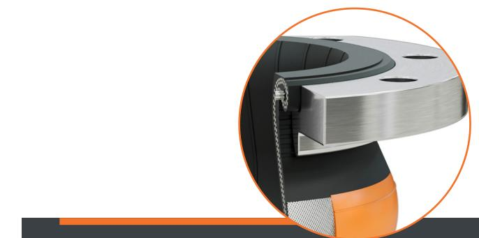
Pour répondre aux différentes exigences de pression et de température, différents renforts (fibres synthétiques ou câble d'acier) sont utilisés dans la couche intermédiaire du soufflet en élastomère. Pour plus de stabilité, le collet en élastomère est renforcé par une trame et un anneau, servant de joint (voir illustration).
