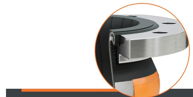
Para diferentes requisitos de presión y temperatura, se utilizan diferentes soportes de resistencia dentro de la capa intermedia de los fuelles de goma. El fuelle de goma es autosellante y, además, está reforzado con núcleos de acero para mayor estabilidad (el cord de acero que sobresale en la imagen).
